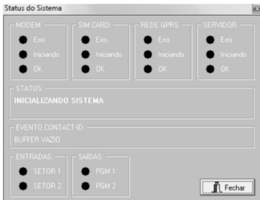
Os quatro campos superiores mostram detalhadamente o estado atual de cada etapa do processo de inicialização do sistema: MODEM, SIM CARD, GSM/GPRS e SERVIDOR.
